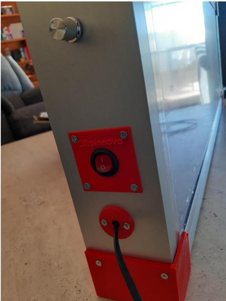
Hemos incluido un potenciómetro para el control de la intensidad de la luminosidad del crono. De esta manera nos permite una correcta visualización indoor y en carreras nocturnas, ya que la alta intensidad de los leds puede provocar deslumbres tanto al público como a los animales.
