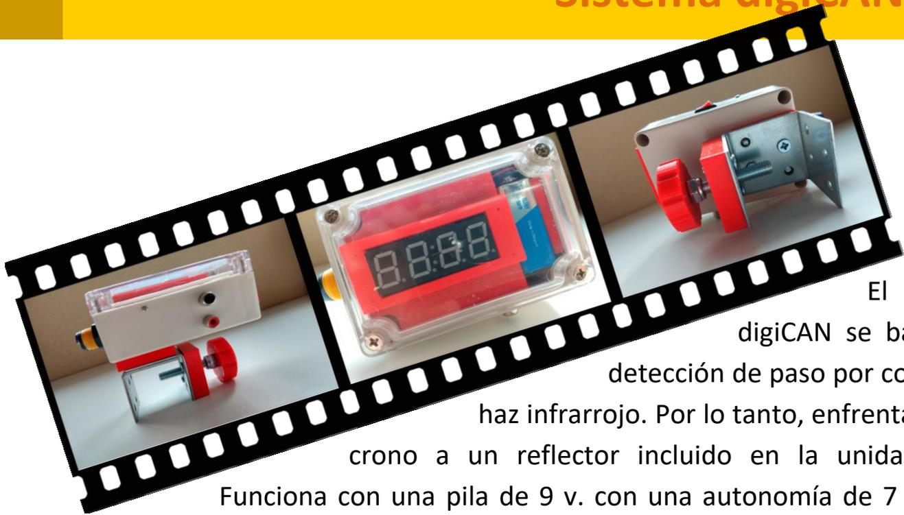
El crono digiCAN se basa en la detección de paso por corte de un haz infrarrojo. Por lo tanto, enfrentaremos el crono a un reflector incluido en la unidad básica. Funciona con una pila de 9 v. con una autonomía de 7 horas. La separación máxima entre crono y reflector es de dos metros.
