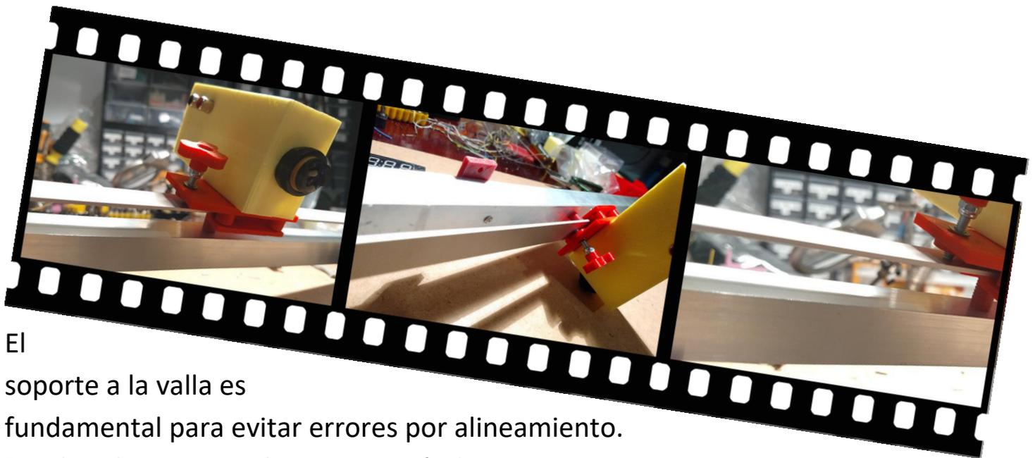
El soporte a la valla es fundamental para evitar errores por alineamiento. Puedes elegir entre el soporte estándar o este nuevo sistema que se adapta a un rail de aluminio por el que deslizará tanto el crono como el reflector. Necesitarás este sistema para acoplarlo a tus vallas.
